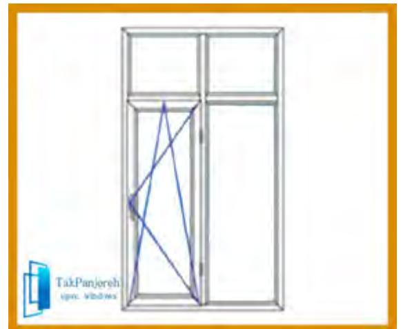
پنجره دو لنگه با یک بازشوی دو حالتی با کتیبه قیمت هر مترمربع ۷۱۵۰۰۰ تومان
