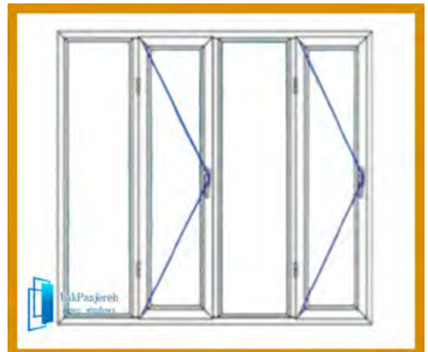
پنجره چهار لنگه با دو باز شوی تک حالته بدون کتیبه قیمت هر مترمربع ۶۱۵۰۰۰ تومان
